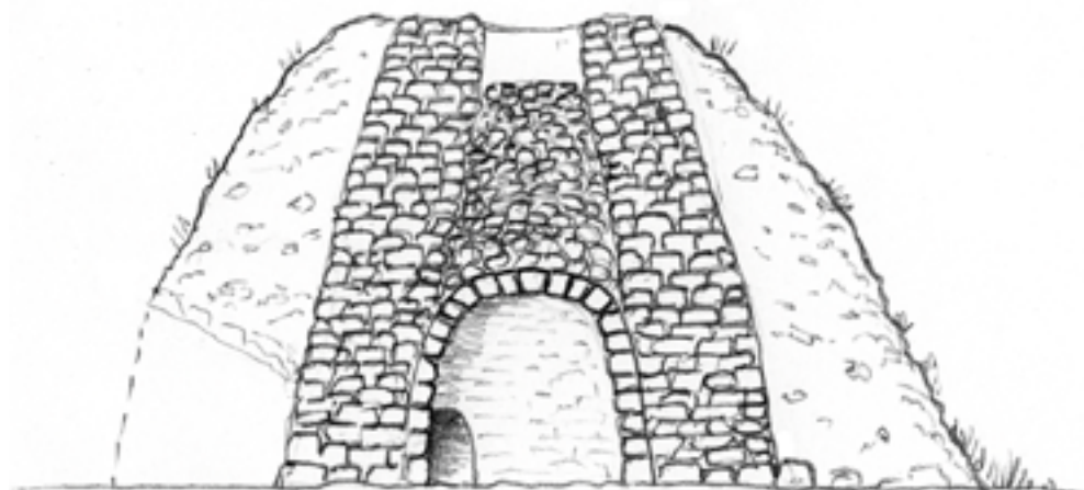
schéma d'un four à chaux primitif (d'après Clément Martin "La garrigue et ses hommes")
